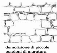
demolizione di piccole porzioni di muratura
